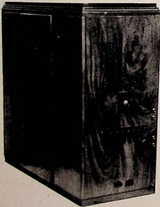
Fig. 2. Het éénlamps-drukknop toestel uitwendig. Alle aansluitingen en bedieningsknoppen zijn op één zijwand gemonteerd.
